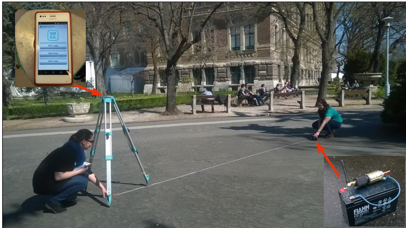
2. ábra. Olcsó GPS-blokkoló mobiltelefonba épített GNSS-vevőre gyakorolt hatásának vizsgálata. A blokkoló és a GPS-vevő távolságát mérőszalaggal mérjük.
