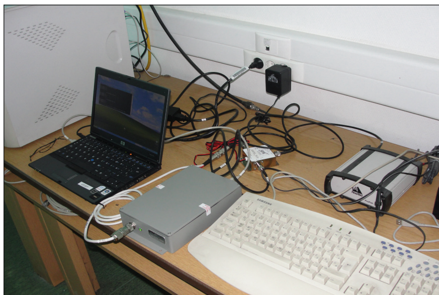
7. ábra. Antennamegosztó, DINTEL-spektrumanalizátor, és GPS-vevő
