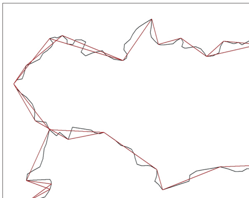
1. ábra. Határvonalak hibás egyszerűsítése (vörössel), ha a poligonokat külön-külön egyszerűsítjük, és nem vesszük figyelembe a kritikus pontokat
