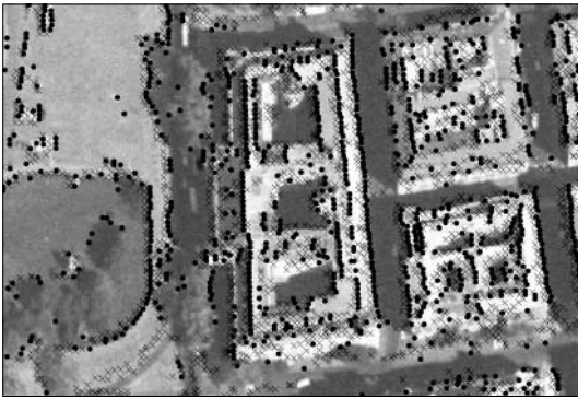
2. ábra Az ImageStation (ponttal jelölve) és az LPS (X-szel jelölve) automatikus kiértékelés során kapott pontok elhelyezkedésének összehasonlítása
