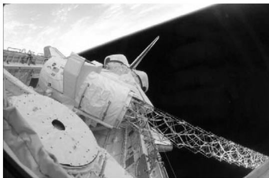
1. ábra. Az SRTM-berendezés az Endeavour űrrepülőgép fedélzetén, jobbra a második radarantennát tartó, 60 méter hosszú állvány látszik (NASA felvétel)
