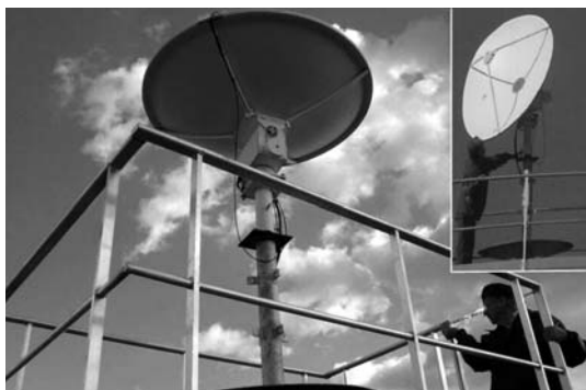
1. ábra. Az antenna kísérleti üzeme a 1,5 méteres parabolaantennával
