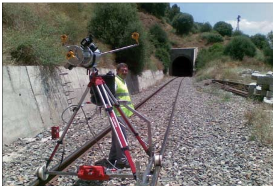
3. ábra Speciális szkennőállvány (forrás: rieggl.com)
