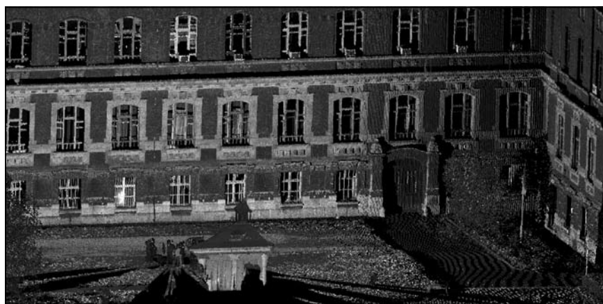
4. ábra Lézerszkennelt pontfelhő intenzitásképe
