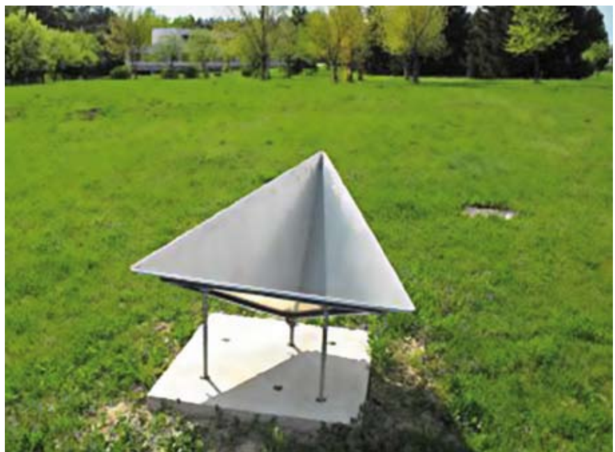
4. ábra A KGO területén létesített mesterséges radar szórópont.
