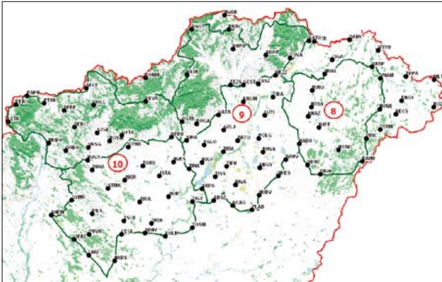
1. ábra A KMO1-2 újramért szintezési vonalai és az ott létesített, központosan mért integrált pontok
