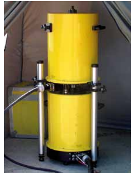
5. ábra Az A10 jelű terepi abszolút graviméter
